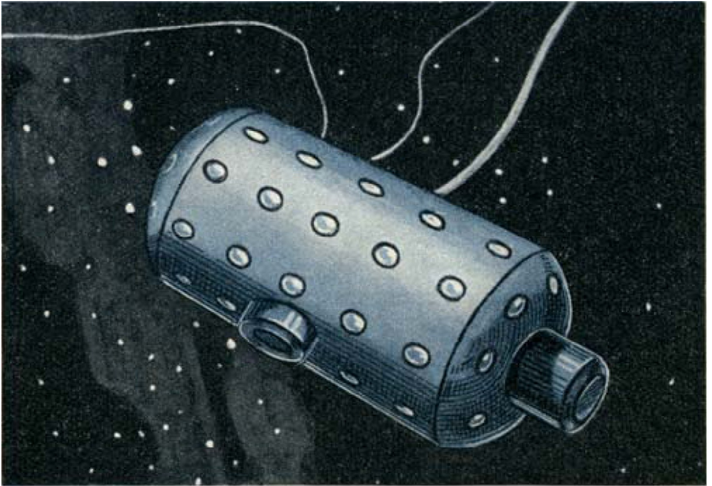
Fig. 91. Exemple de réalisation d'observatoire. Il a approximativement la forme d'une chaudière en raison de la surpression interne de 1 atmosphère. On peut voir le sas à air, les deux câbles électriques (à gauche), le tuyau d'air flexible (à droite) et les hublots d'éclairage.
